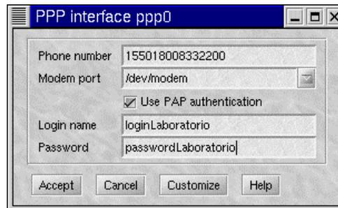
Figura 51. Datos para la configuración de la interfaz ppp0
