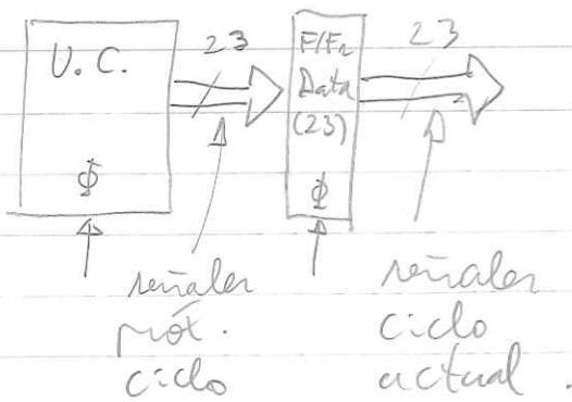
De esta forma se suprime la componente (a) del período del reloj. Notar que esta optimización no sería posible aplicarla si no existiera el ciclo **Decode**, pues la instrucción que fijará las señales de control que se aplicarán en el ciclo **Ejecutar**.
