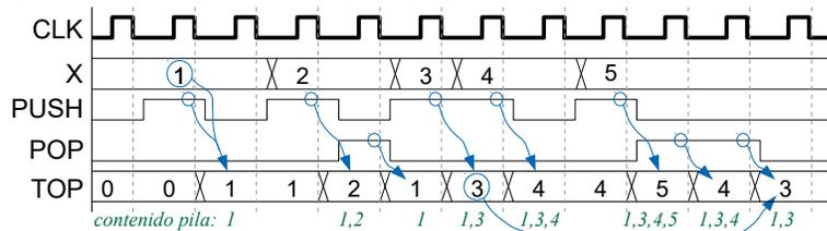
Implemente STACK usando el banco de registros de M16. Por simplicidad considere que al inicio todos los registros y flip-flops data valen 0 y por lo tanto la pila está vacía. No se preocupe por el desborde de la pila o una operación POP con la pila vacía. No hay operaciones PUSH y POP simultáneas.
