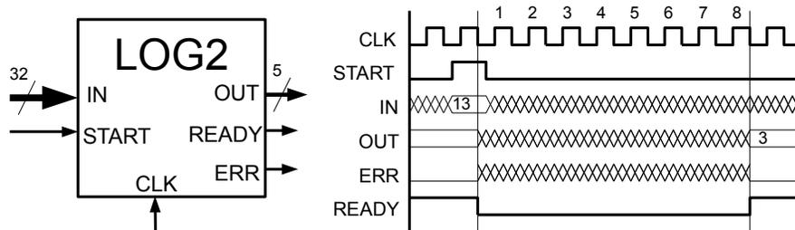
**I.** El circuito LOG2 de la figura recibe como entrada un número IN de 32 bits sin signo y calcula eficientemente la posición del bit en 1 más significativo de IN. LOG2 inicia el cálculo cuando START se pone en 1. La línea READY se va a 0 mientras se realiza el cálculo. El término del cálculo se señala llevando
