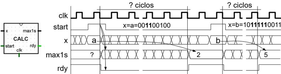
Use diseño modular para implementar el circuito *CALC* de la figura. Este circuito entrega en la salida *max1s* el máximo número de bits consecutivos en 1 encontrados en la entrada *x*, correspondiente a un entero de 32 bits sin signo. Por ejemplo si  $x=00\dots001100100$ , *CALC* debe entregar 2 y si  $x=00\dots0010111110011$ , *CALC* debe entregar 5.
