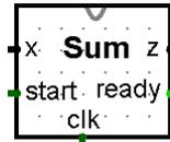
Implemente el circuito *sum* usando un solo sumador de 32 bits. Use además un registro *RegSum* de 32 bits para ir almacenando las sumas parciales de los 8 números y otro registro *RegX* para almacenar inicialmente  $x$  y luego desplazarlo en 4 bits en cada ciclo. También necesitará usar multiplexores, un desplazador (shifter), un comparador, un *and* bit a bit con entradas y salidas de 32 bits, más otras compuertas. Use este algoritmo para realizar el cálculo:
