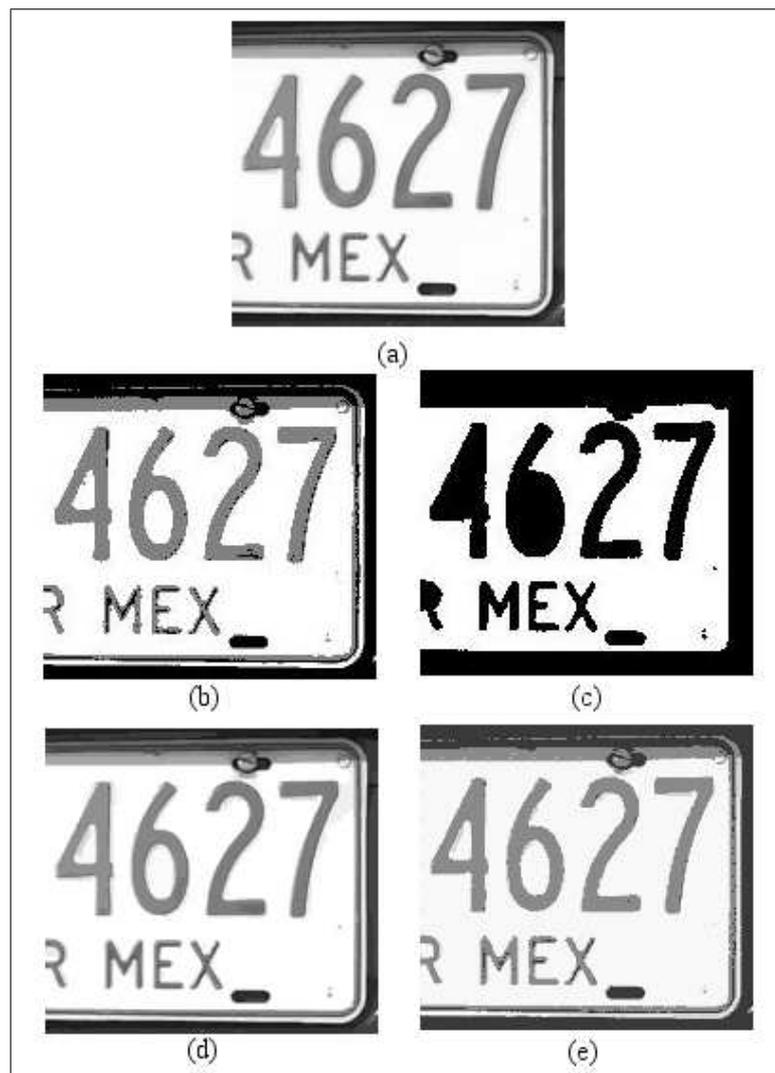
Figura 7.1: (a)Imagen Original.(b)Imagen segmentada usando Multiumbral. (c)Imagen segmentada usando Crecimiento de Regiones.(d)Imagen segmentada usando Split-Merge. (e)Imagen segmentada usando Mumford-Shah.
