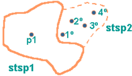
Figura 4.6: Mecanismo de mezclado del conjunto de nodos ( t -Spanner 4). Los elementos de stsp_2 se insertan al sub- t -spanner mayor, stsp_1 , de acuerdo a la cercanía al representante p_1 .
