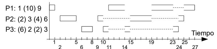
Junto a cada proceso se indica la duración de las ráfagas de CPU y entre paréntesis la duración de los estados de espera. La línea punteada indica cuando el proceso esta READY y el espacio en blanco que está en estado de espera. En tiempo 10 el scheduler decide ejecutar P3 quedando en la cola P2; en 11 decide ejecutar P1, quedando en la cola (P3, P2) en ese orden; en 14 decide ejecutar P3, quedando en la cola (P2, P1).
